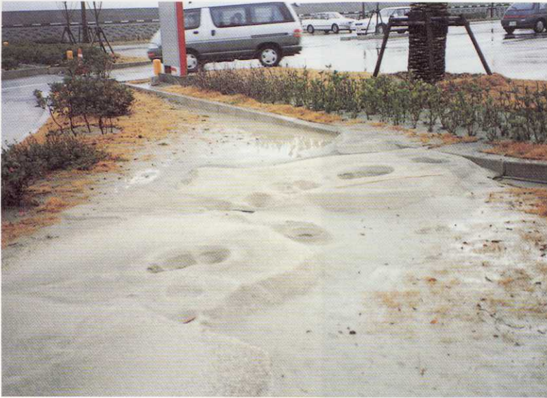
写真-19 津名町志筑・志筑新島 ショッピングセンターとなっているこの地区でもいたる所で噴砂が見られた。ここでは、乾燥した埋立て砂も噴き出していた（採取番号-27）。
