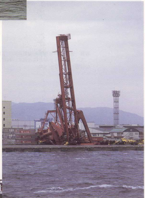
写真-84 神戸市東灘区向洋町東 六甲アイランド南東部にある岸壁が海側に移動したため、荷役機用のレールが折れ曲がった(1月21日)。
