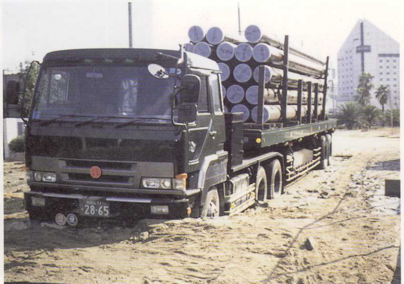
写真-35 神戸市中央区港島2丁目 道路上を全面的に覆った液状化した砂の中にトラックが埋まっていた（採取番号-2）。
