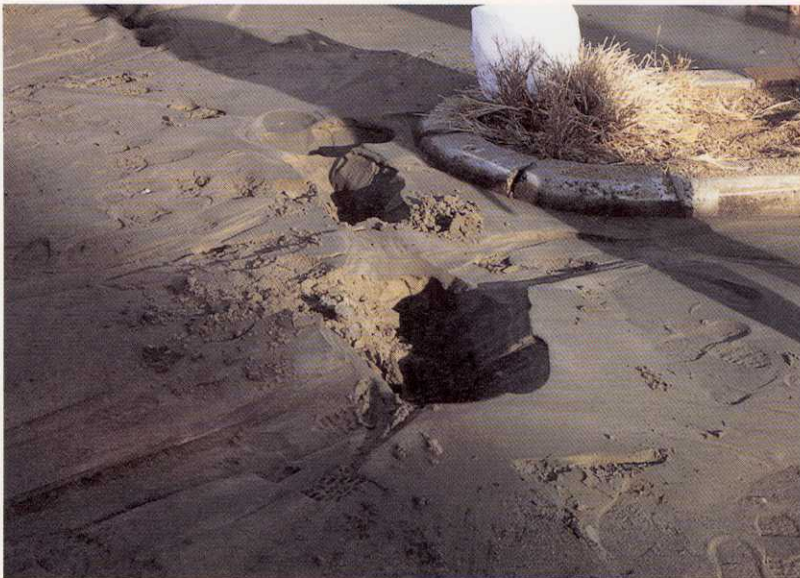
写真-126 大阪市港区海岸通2丁目 天保山・大阪港駅・中央突堤などがあるこの埋 立地では所々で噴砂が見られた(1月21日)。
