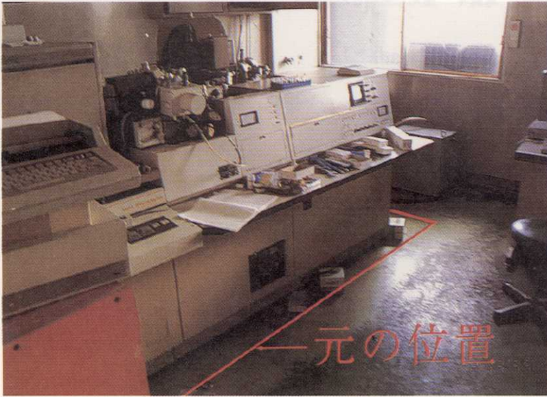
写真1 壁に激突してしまったGC/MS (公害研究所)
