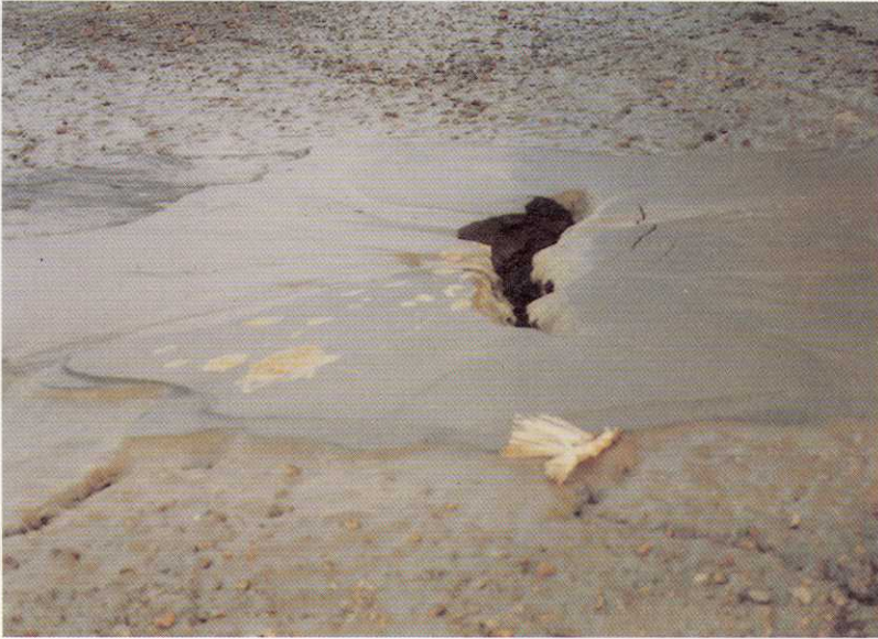
写真-115 西宮市甲子園浜 噴砂孔から粘性の高い異物が飛び出した（1月20日）。
