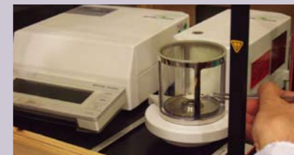
精密電子天秤による重量測定 (静電気除去装置を通してガラス風防のある秤量台に乗せる)
