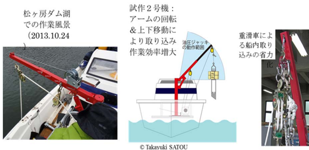
図 2-15 底泥コア採取用の小型船舶に設置可能なモバイルクレーンシステムの開発
