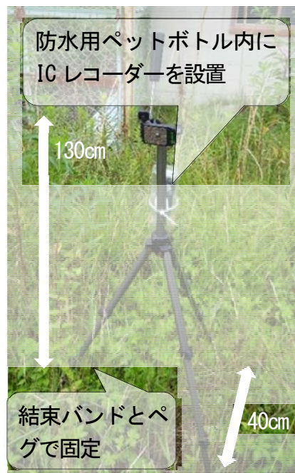
図 3.3-5 録音機材の設置方法
