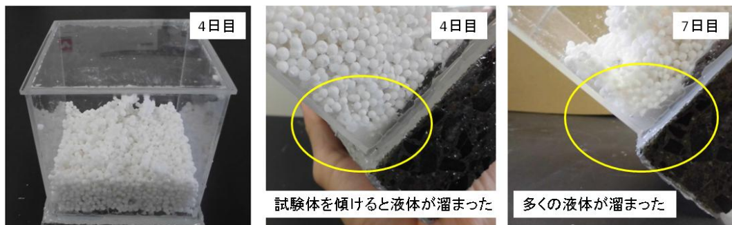
図 1.4-31 厚さ 50mm の試験体の状態
