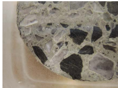
図 1.4-18 材齢 6 ヶ月における各種 飛灰抽出模擬液に浸漬した試験体 (Na/K/Ca系)
