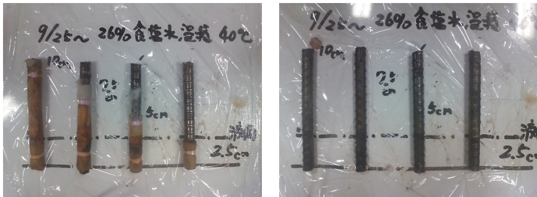
図 1.4-2 鋼材腐食試験の予備検討における腐食状況
