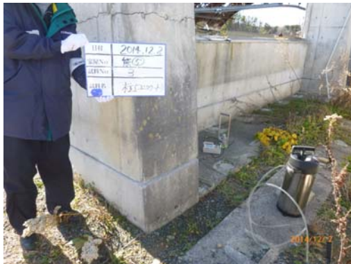
図 1.3-6 倒壊した臨海建築物 No. 3 コンクリート柱北側面(左) No. 4 側溝蓋(右) (空間線量率 5.8 \mu Sv/hr)
