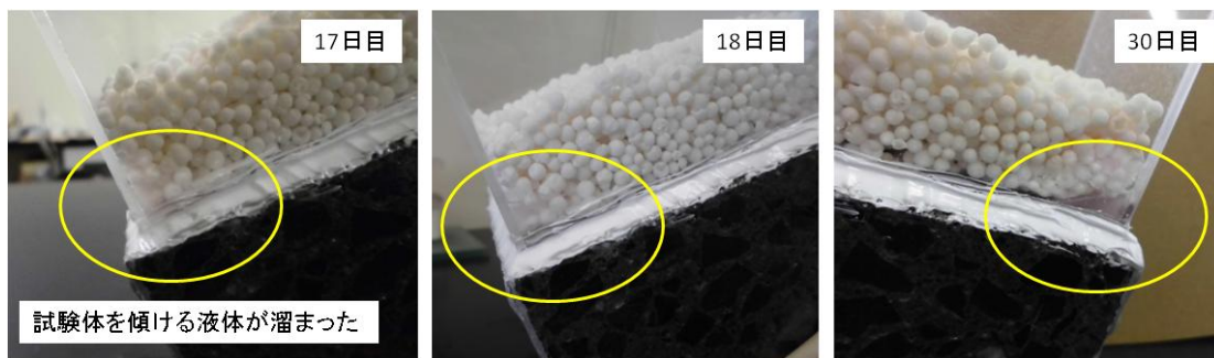
図 1.4-33 厚さ 100mm の試験体の状態変化
