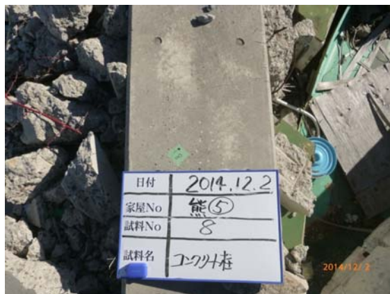
図 1.3-8 倒壊した臨海建築物 No.7 倒壊柱破断面(左) No.8 倒壊柱表面(右) (空間線量率 5.8 \mu\text{Sv/hr} )
