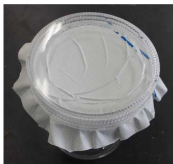
透湿防水シートにシワが寄っていた
