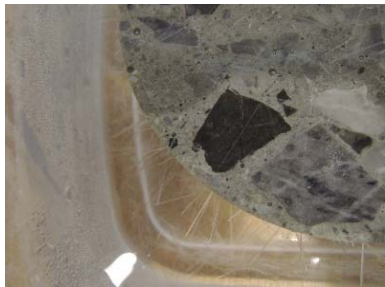
図 1.4-18 材齢 6 ヶ月における各種 飛灰抽出模擬液に浸漬した試験体 (Na/K/Ca系)
