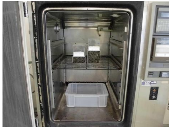
図 1.4-28 恒温恒湿槽内への試験体設置状況
