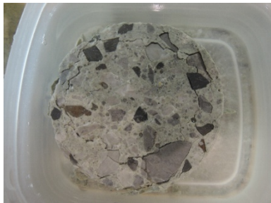
0-0-30 20°C (モルタル浮きひび割れ大)
