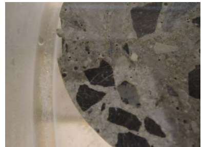
図 1.4-18 材齢 6 ヶ月における各種 飛灰抽出模擬液に浸漬した試験体 (Na/K/Ca系)
