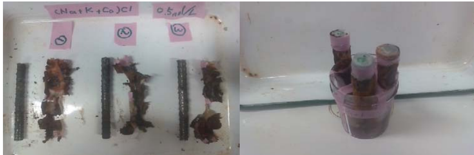
図 1.4-3 ケース①NaCl, KCl, CaCl 2 (Cl)0.5M の腐食状況
