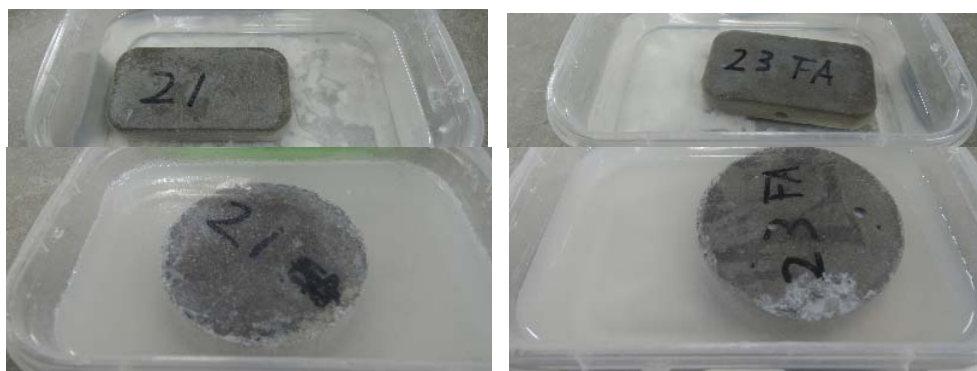
図 1.4-24 焼却飛灰抽出模擬液へのコンクリート試験体の浸漬状況（4ヶ月経過後） （上段：20℃浸漬、下段：40℃浸漬）
