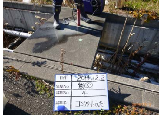
図 1.3-6 倒壊した臨海建築物 No. 3 コンクリート柱北側面(左) No. 4 側溝蓋(右) (空間線量率 5.8 \mu Sv/hr)
