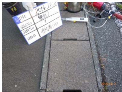
図 1.3-5 No. 1 工場内側溝蓋(左) No. 2 土間コン(右) (空間線量率 5.9 \mu Sv/hr)
