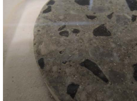
図 1.4-18 材齢 6 ヶ月における各種 飛灰抽出模擬液に浸漬した試験体 (Na/K/Ca系)
