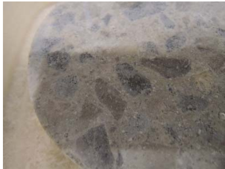
図 1.4-18 材齢 6 ヶ月における各種 飛灰抽出模擬液に浸漬した試験体 (Na/K/Ca系)
