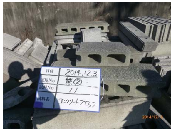
図 1.3-9 No.9, 10 高線量地区側溝蓋(左) (空間線量率 22.3 \mu\text{Sv/hr} ) No.11 コンクリートブロック(右) No.14 は No.11 の側面 (空間線量率 12.5 \mu\text{Sv/hr} )
