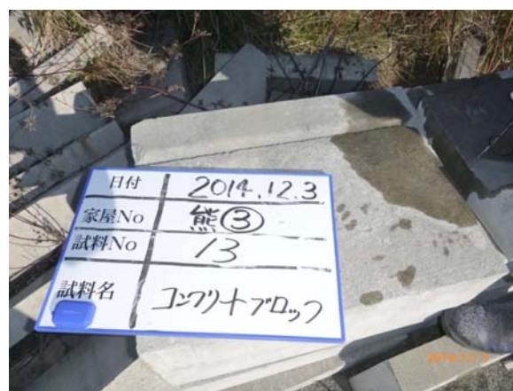
図 1.3-10 No.12 大谷石(左) (空間線量率 12.5 \mu\text{Sv/hr} ) No.13 コンクリート製品ブロック(右) (空間線量率 6.35 \mu\text{Sv/hr} )
