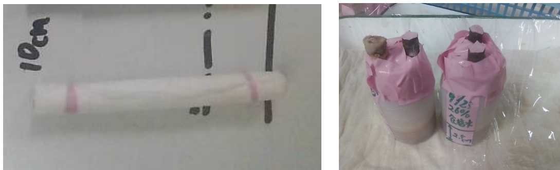
図 1.4-1 鋼材腐食試験における浸漬紙巻き高さ検討のための予備検討の状況 (左：吸水紙巻き高さ 100mm とした鋼材(浸漬前)、右：鋼材の塩水への浸漬状況)
