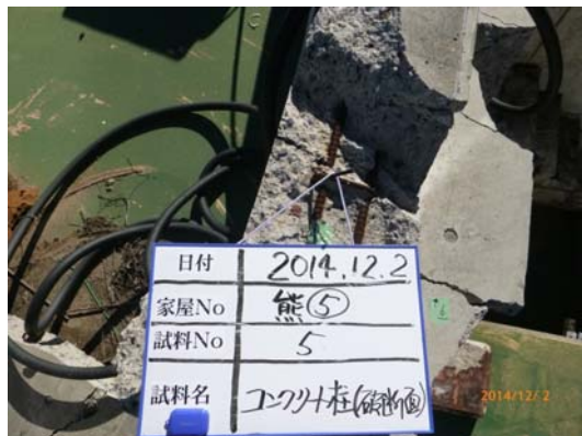
図 1.3-7 倒壊した臨海建築物 No. 5 倒壊柱破断面(左) No. 6 倒壊柱表面(右) (空間線量率 5.8 \mu Sv/hr)
