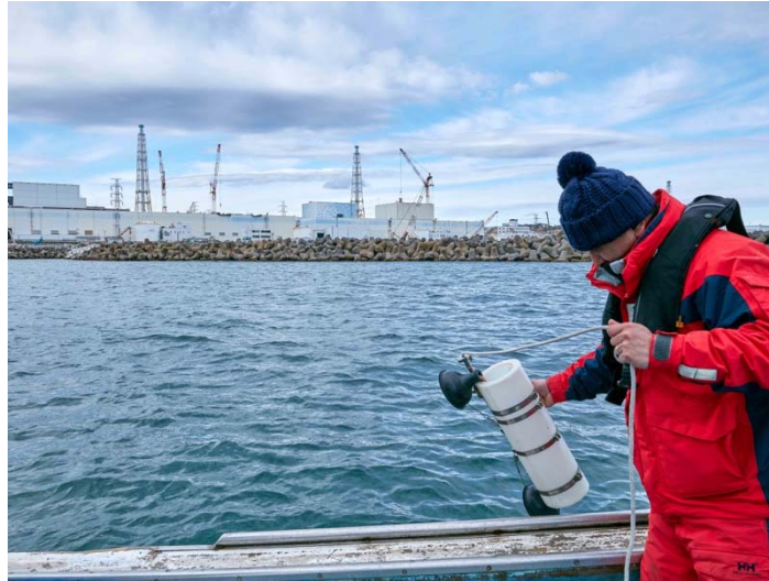
図 4.4-4 福島第一原発の南放水口前観測点における採水風景
