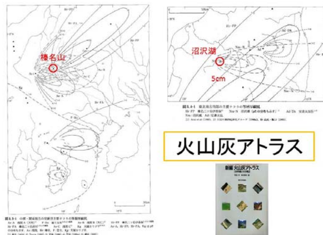
図 3.11-13 火山灰アトラスによる堆積コアの広域テフラの推定
