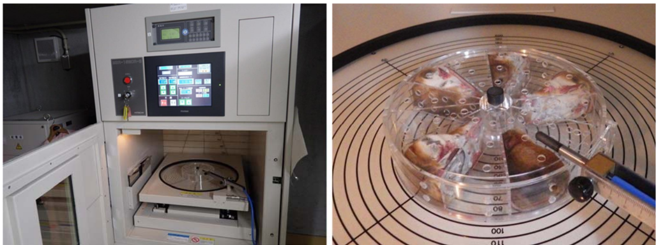
図3.5-2 X線照射実験に使用した実験用X線照射装置MBR-1520R-3（日立）
